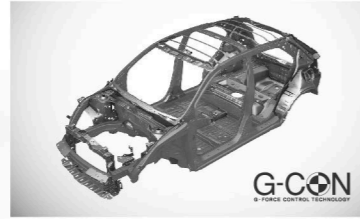
โครงสร้างตัวถังมิกซ์ G-CON และ ACE™ ปกป้องห้องโดยสารจากการชนรอบทิศทาง
