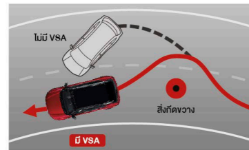
Vehicle Stability Assist (VSA) ระบบช่วยควบคุมการทรงตัวขณะทำไถ่
